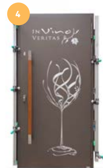
Finální testování hotových dveří ve zkušebním stojanu
